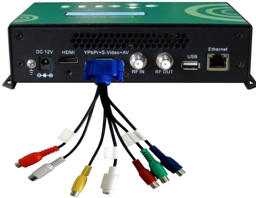
YPbPr + S-Video + AV to VGA Adapter For video & audio input
